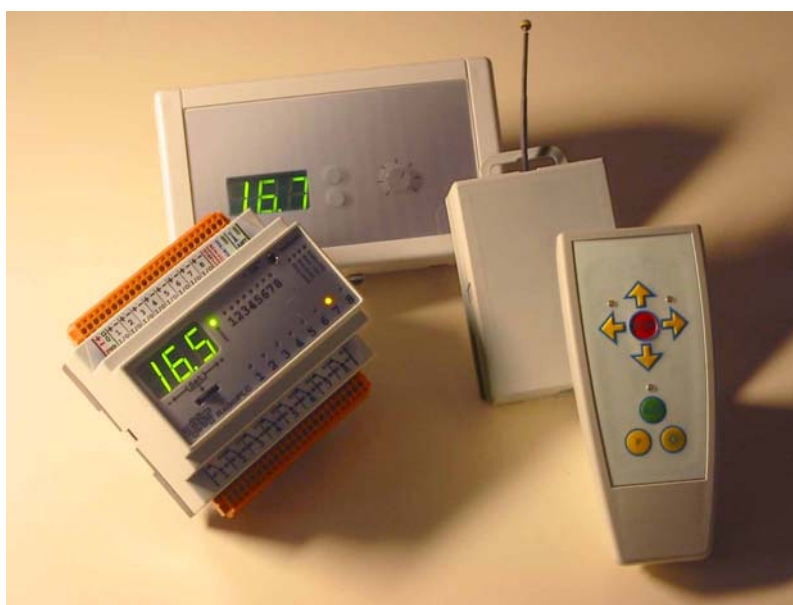
Radiostyrning och PLC (styrenhet) i ett, RadioPLC ® , en produktfamilj.
